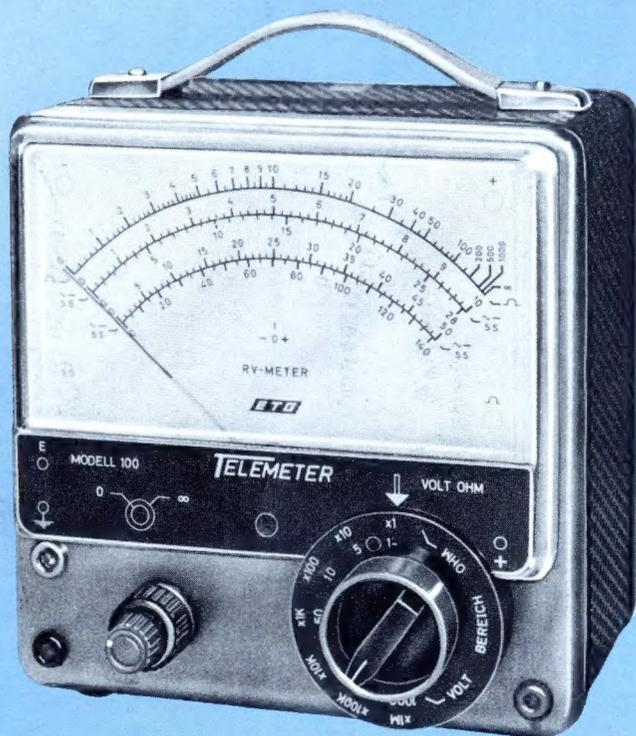
**TELEMETER 100.** Elektronisches Volt-Ohm-Meter für Gleich-, Wechsel- und  $\text{dB}$ -Spannungen. 1 V - 1000 V S.E. 32 Meßbereiche. Standardeingangswiderstand 11 M $\Omega$ . (Großes Meßwerk), 130 mm Zeigerweg.
