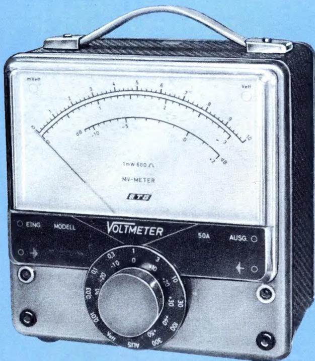
**VOLTMETER 50 A.** NF-Millivoltmeter. 10 mV - 300 V<sub>eff</sub> S.E. Frequenzgang 10 Hz - 50 kHz. Gleichspannung stabilisiert. dB-Skala von -10 dB bis +2 dB. dB-Bereiche von -40 bis +50 bezogen auf 1 mW/600  $\Omega$ . (Großes Meßwerk), 130 mm Zeigerweg.
